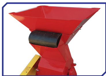
Entrada para espiga de milho e reservatório para grãos de 40 kg, Triturador 202.
